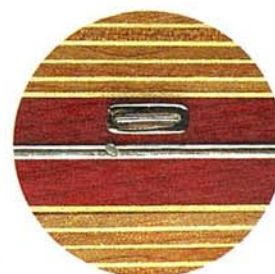
5. Madera barnizada con 10 capas para obtener un efecto espejo.
